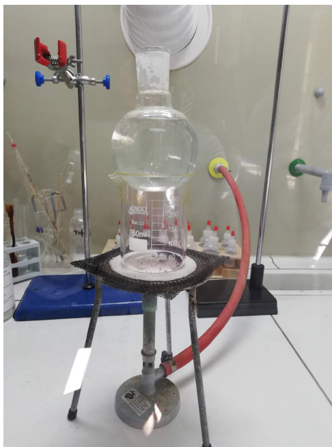
Zdjęcie 7. Ustawienie zlewki i kolby kulistej na trójnogu z siatką ceramiczną (fot. P. Kachel)
